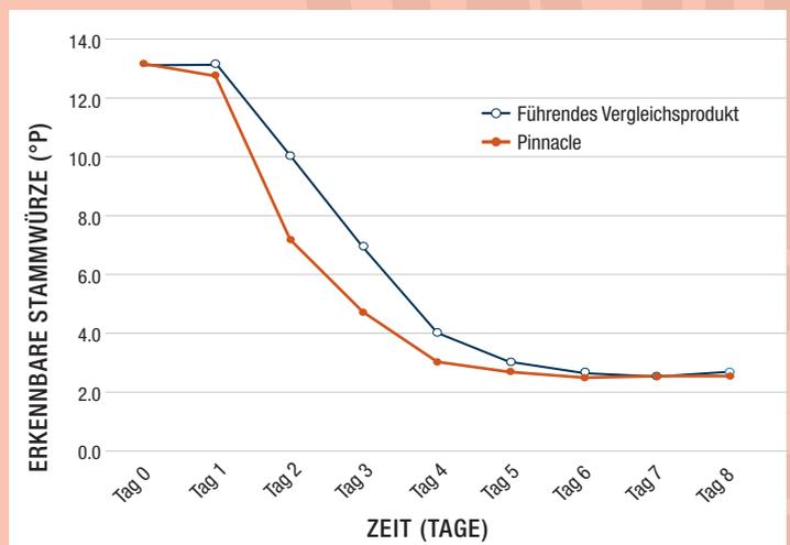
Vergleich von Pinnacle Heritage American Ale mit einem führenden Marktprodukt in einer 13°P Würze, fermentiert bei 20°C (68°F)
